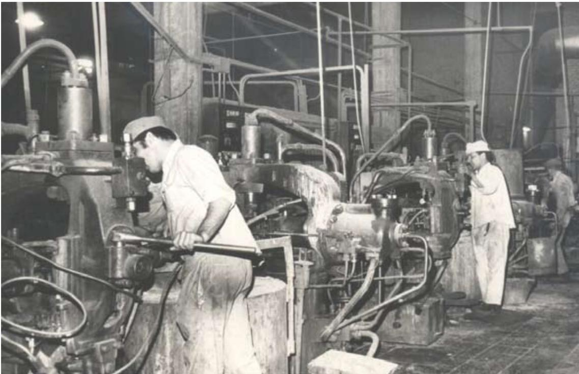
Fundición a presión en la vieja planta de FV. 1960.
