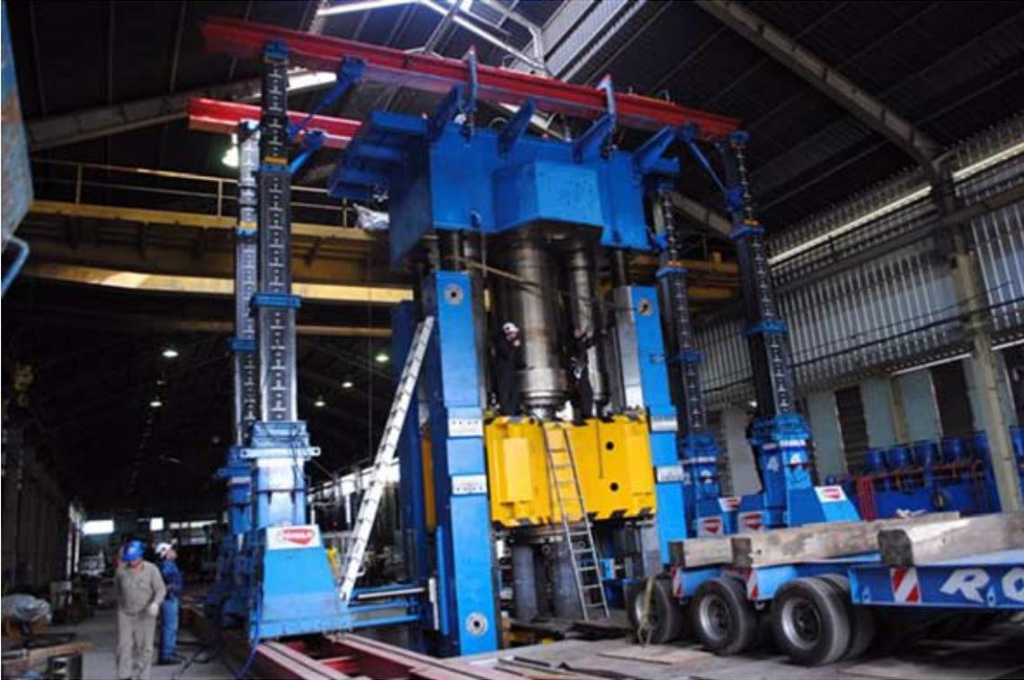
Operación de montaje de la nueva prensa de 3.500 toneladas, para la fabricación de componentes de molinos de energía eólica.
